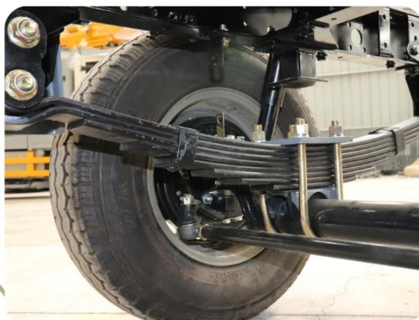
Système de suspension à lame \*
